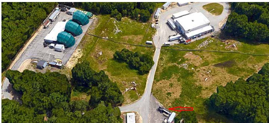
Satelitarne zdjęcie części ośrodka w Pelham. Po lewej, na wzniesieniu (teren jest bardziej pofalowany niż wynika to ze zdjęcia) widać trzy zamknięte osłony stanowisk z radiolokatorami. Pierwsze od góry mieści prototypowe stacje z AESA. Podczas pracy skierowane są w prawą stronę zdjęcia. U jego dołu strzałka wskazuje wyrzutnię (bez pojemników z pociskami), której używa się do testów współdziałania z nowymi stacjami.
