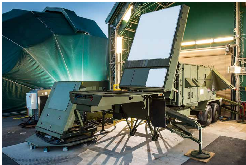
Prototypowa stacja radiolokacyjna z AESA na bazie GaN na stanowisku w Pelham. Obok, po lewej, widać prototypową antenę boczną. Na zasłoniętym stanowisku w tle ustawiono stację AN/MPQ-65 do testów porównawczych.
